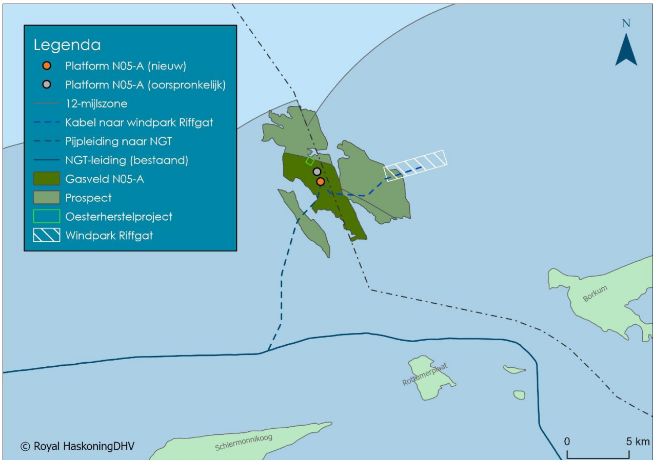
Abbildung 1-1: Ursprünglicher und neuer Standort der Förderplattform, einschließlich der Lage der Gasfelder und der neuen Trassen der Gaspipeline und des Kabels zum Windpark Riffgat.
